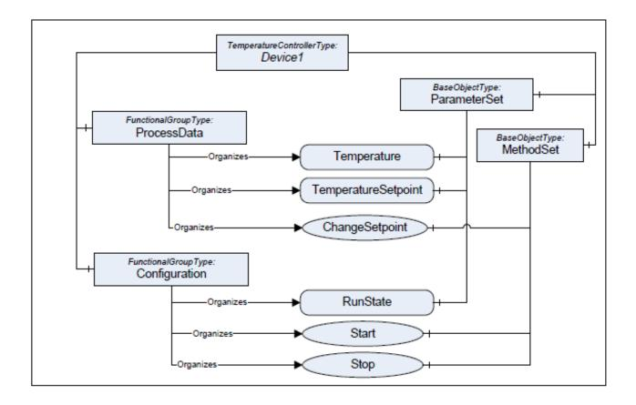
Figure 8 OPC UA Device Example
